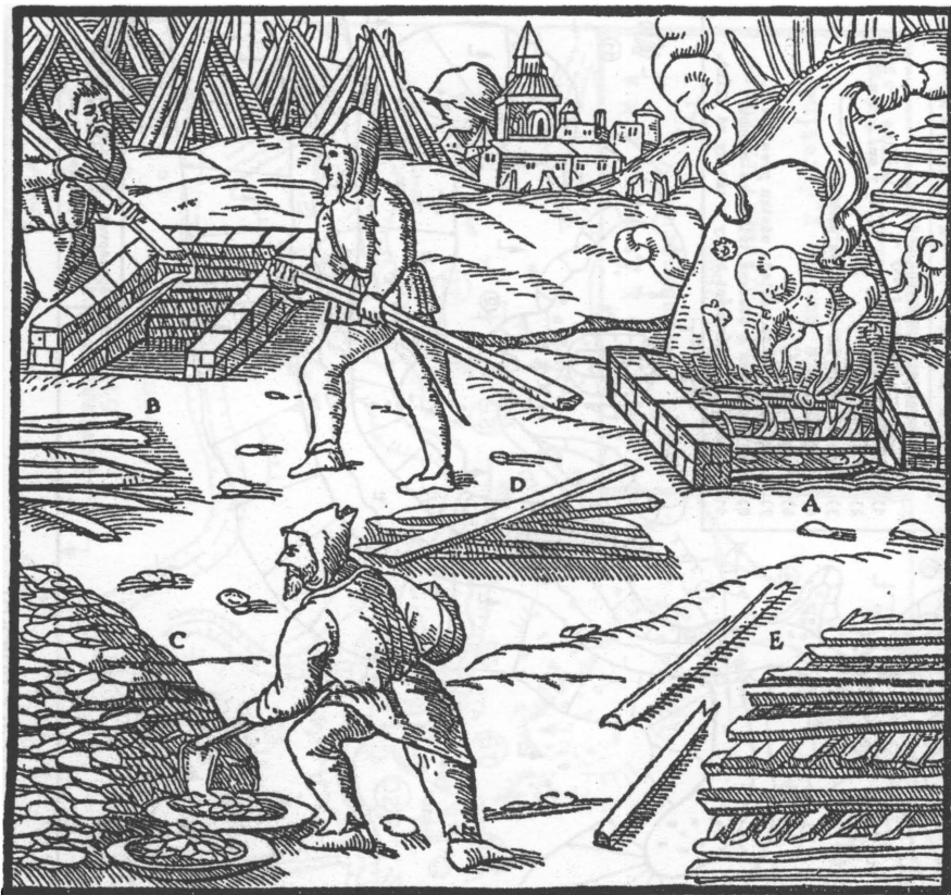
Zapálené pražiště A. Pražiště, které se připravuje B. Ruda C. Dřeva D. Hranice dřev E.
