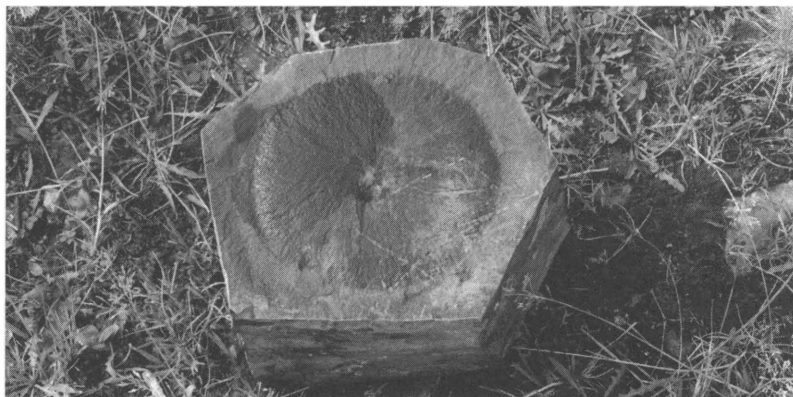
Obr. 10. Úlomek sloupce hlavního tělesa s kruhovitě vyklenutou lomnou plochou. V jádře úlomek křemenného zrna (Foto autor). – Bruchstück einer Säule des Hauptkörpers mit kreisförmig gewölbter Bruchfläche. In der Mitte ein Quarzkorn.
