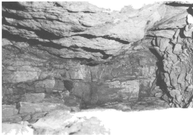
Obr. 4. Čelba štoly č. 1 na severozápadním okraji polzenitové žíly. Vlevo polzenit, vpravo kontaktní stěna pískovce. V čelbě vystupuje rozložená okrajová polobola polzenitové žíly s bohatšími obsahy železa v pravé části při pískovci (Foto V. Štěpánský)
