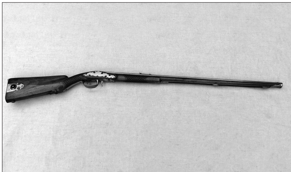
Obr. 6. Vzduchovka s válcem v pažbě a výklopnou hlavní Josefa Rutteho ve sbírce VHÚ Praha, inv. č. II-1646. Foto J. Šach.
