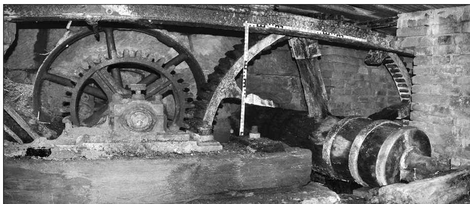
Obr. 9. Suterén brusírny – pohled k jihu na interiérovou část hřídele s palečným kolem a převodový mechanismus (vlevo). Foto I. Peřina, listopad 2012.
