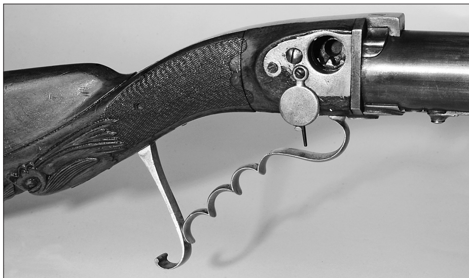
Obr. 9. Detail natahovacího mechanismu vzduchovky Josefa Rutteho. Foto V. Štěpánský.
