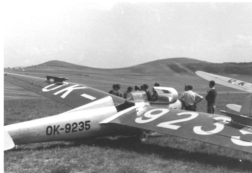
Obr. č. 1: Dvoumístný větroň DFS Kranich na letišti v Medlánkách Zdroj: Osobní archiv Petra Prchala
