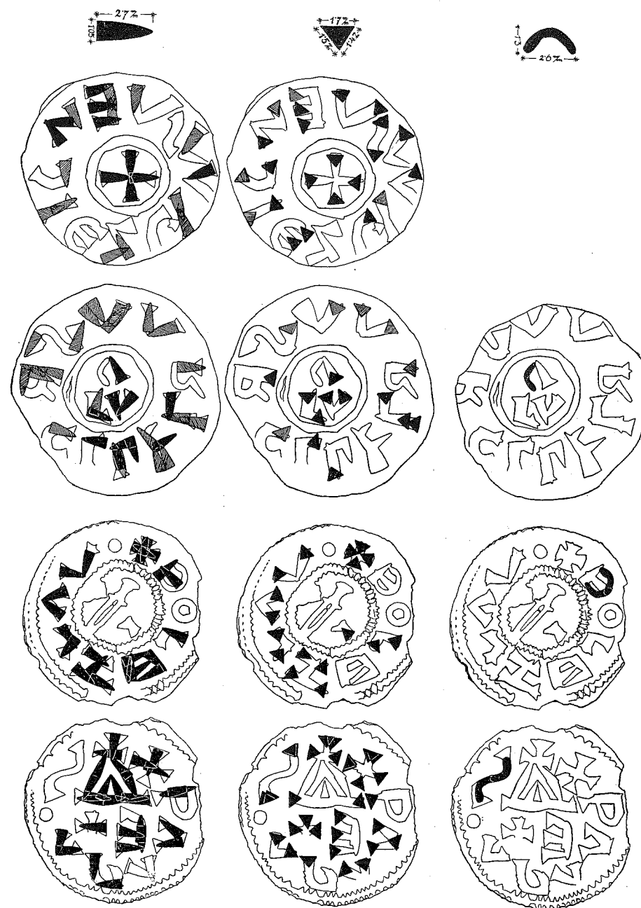
Diagram použití společných punců při výrobě razidel. Zvětšeno a sestaveno dle několika denárů. Černé punce jsou měřeny dle originálů, čárkované dle sádrových odlitků.
