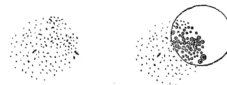
Obr. 1. Jodazidová reakce na sirníky. — Vlevo jsou zkoumané částičky před provedením reakce, vpravo po nakápnutí zkoumadla. (Hnědá barva zkoumadla není naznačena.) V horní části je několik partikulí, které nejsou tvořeny sirníkem stříbrným, neboť ve styku se zkoumadlem se kolem nich nevyvinou žádné bublinky plynu (dusíku). — Zvětšeno lupou asi 5krát.
