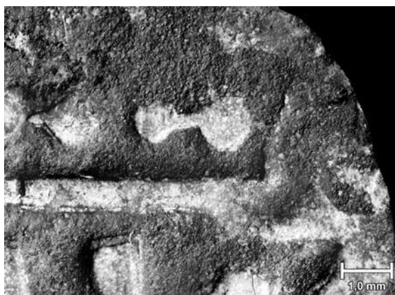
Obr. 1. Makrofotografie falza č. 2 – detail části koruny a litery W s dobře patrnými zbytky pokovení v místech nevystavených otěru. 7
